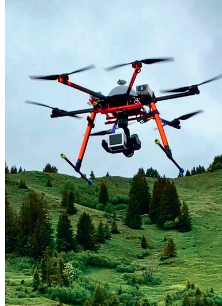
Multikopter mit Wärmebildkamera, wie er für die Rehkitzrettung eingesetzt wird.
